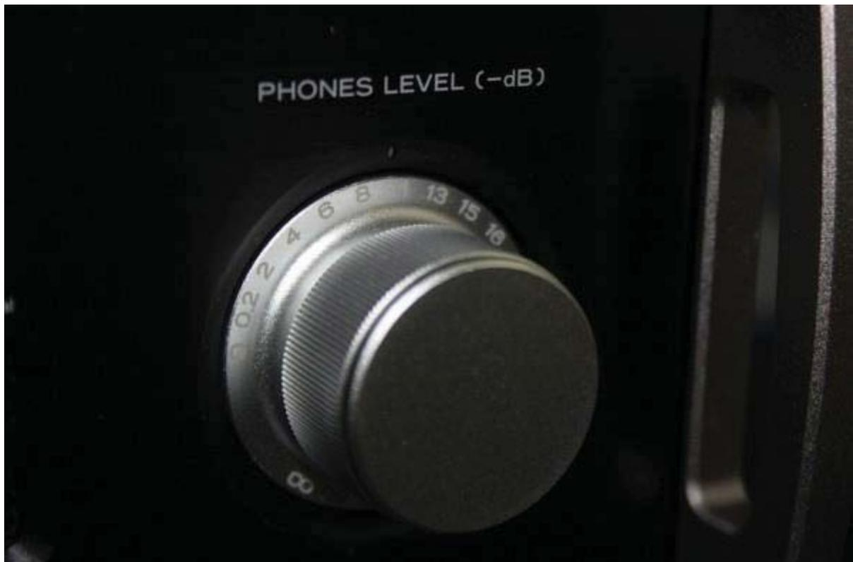
La façade avant est très soignée, épaisse, en aluminium brossé avec un interrupteur à levier, une sortie casque 6,35 mm amplifiés, un bouton rotatif sélecteur de sources, un bouton « Menu » pour les réglages, un afficheur digital de couleur ambrée, très joli, et un potentiomètre de volume très précis pour la sortie casque. Notez que ces boutons sont également en aluminium épais, et très solide. Vraiment, je me répète, mais cette construction est exemplaire !
